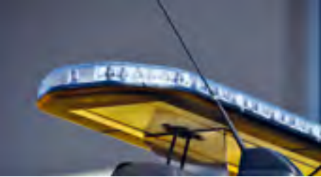
Lichtbalken auf Dach LED (Muntermann)
