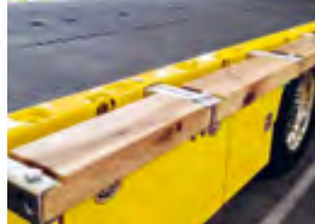
Extension manuelle du plateau avec du bois jusqu'à 3 mètres
