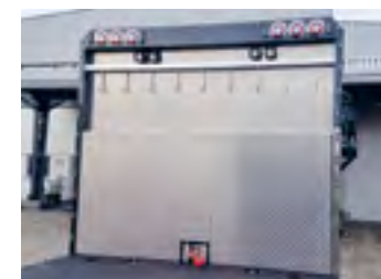
Paroi arrière en tôle striée (de la même hauteur que le véhicule)
