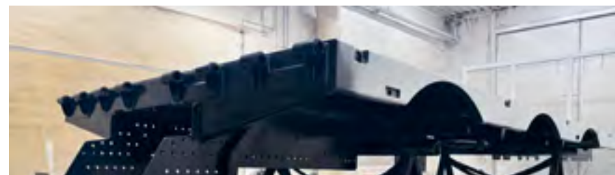
Protection contre la corrosion : revêtement par cataphorèse du châssis La galvanisation à chaud n'est pas possible (déformation du châssis)
