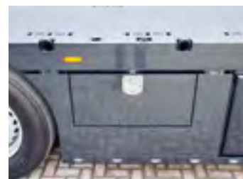
Protection anti-encastrement latérale avec éclairage
