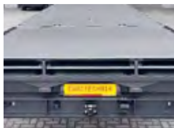
Attelage de remorque sur la rampe arrière (3,5 tonnes)
